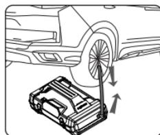
4.1 Verbinden Sie den Luftschauch mit dem Kompressor und ziehen Sie die Mutter fest, verbinden Sie das andere Ende des Schlauchs mit dem Autoreifen.
